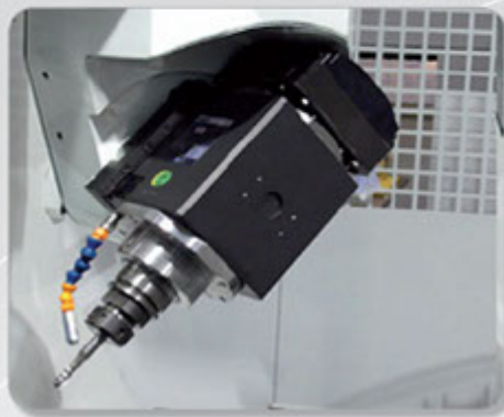
Misuratore lunghezza utensile Tool-setter for tool length measurement
