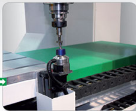
Vasta gamma di dispositivi punta-contropunta gestiti da CN con rotazione continua e interpolata. Wide range of NC-controlled and interpolated headstock and tailstock system.
